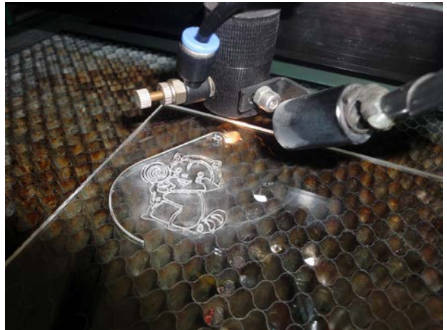
說明：雷射雕刻機運作情形
